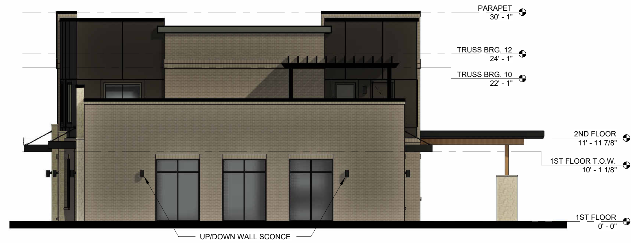
3 EAST ELEVATION SCALE: 1/8" = 1'-0"
