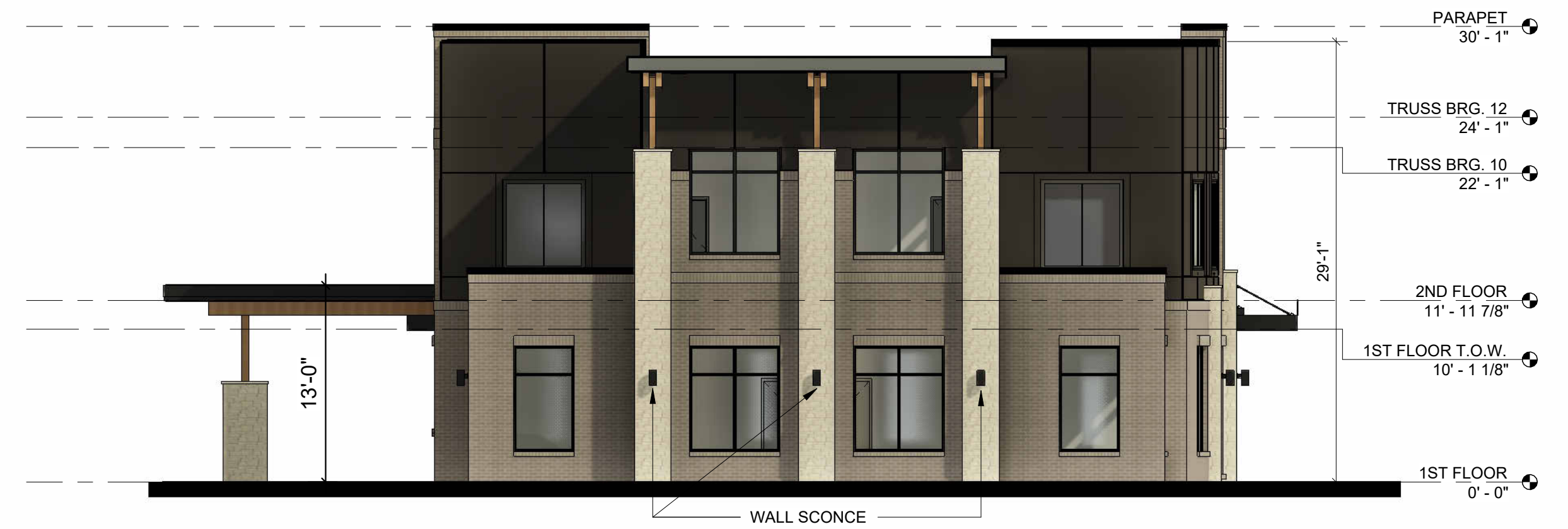
2 WEST ELEVATION SCALE: 1/8" = 1'-0"
